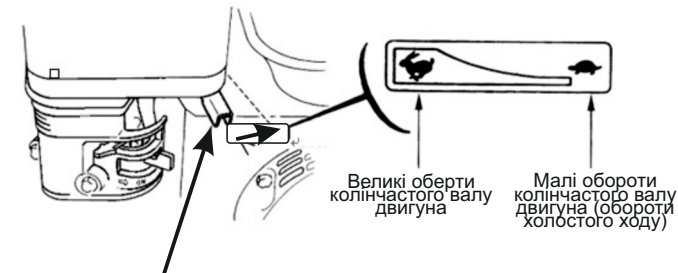
Важіль управління дросельною заслінкою
