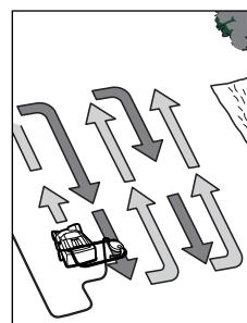
Platzieren Sie den ALR 900/AVR 1100 an der Rasenkante und so nahe wie möglich an der Netzsteckdose. Arbeiten Sie von der Netzsteckdose weg.
