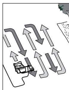
Sett ALR 900/AVR 1100 på kanten av plenen og så nær strøm-stikkontakten som mulig. Arbeid bort fra strøm-stikkontakten.
