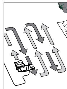
Helyezze el a ALR 900/AVR 1100 berendezést a gyep széléhez, a lehető legközelebb a dugaszoló aljzathoz. Mindig a dugaszoló aljzattól eltávolodva dolgozzon. A kábel minden egyes fordulás után vige át a szemben fekvő, már megmunkált oldalra. A gyeplevezetés/ mélyszellőztetés során ne terhelje túl a motort.
