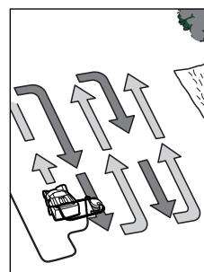
Posicionar o ALR 900/AVR 1100 no canto da relva, o mais perto possível da tomada de rede eléctrica. Trabalhar afastando-se da tomada de rede eléctrica. Ao virar deverá sempre colocar o cabo do lado oposto já trabalhado. Ao ventilar e escarificar a relva **não deverá sobrecarregar o motor**.
