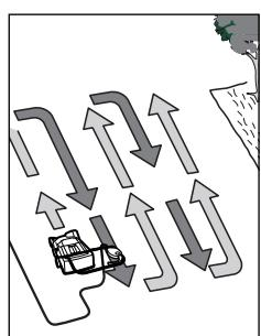
Novietojiet instrumentu ALR 900/AVR 1100 zāliena malā, iespējami tuvu elektrotikla kontaktligzda. Darba laikā pakāpeniski pārvietojeties prom no elektrotikla kontaktligzdas. Pēc katra pagriezena pārvietojet kabeli uz pretējo jau apstrādāto zāliena pusī. Veicot zāliena tīrīšanu/ kultivēšanu, nepārslogojiet instrumenta dzīnēju.
