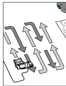
Posizionare l'ALR 900/AVR 1100 sul bordo del prato ed il più vicino possibile alla presa elettrica. Lavorare allontanandosi sempre più dalla presa elettrica. Al termine di ciascun giro, spostare il cavo sul lato opposto già lavorato con la macchina. Arieggiando/scarificando l'erba **non sovraccaricare il motore**.
