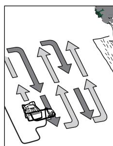
Namestitev ALR 900/AVR 1100 ob rob trate in tako blizu kot je možno k omrežni vtičnici. Delajte v smeri vstran od omrežne vtičnice. Po vsakem obračanju obrnite kabel na nasprotno, že obdelano stran. Pri zračenju/vertikutiranju **ne preobremenujte motorja**.
