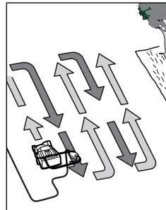
Plaats de ALR 900 of AVR 1100 aan de rand van het gazon en zo dicht mogelijk bij het stopcontact. Werk van het stopcontact weg.
