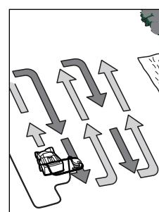
Расположите ALR 900/AVR 1100 у края газона как можно ближе к розетке. Работайте в направлении от розетки. После каждого разворота перекладывайте шнур на противоположную, уже обработанную сторону. При аэрации/культуре газона не создавайте перегрузку для двигателя.
