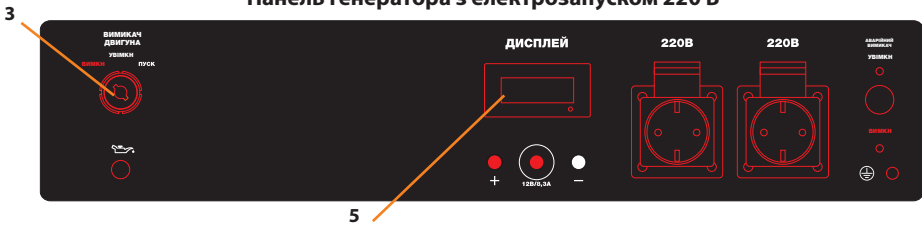
Панель генератора з електрозапуском 220 В та ATS
