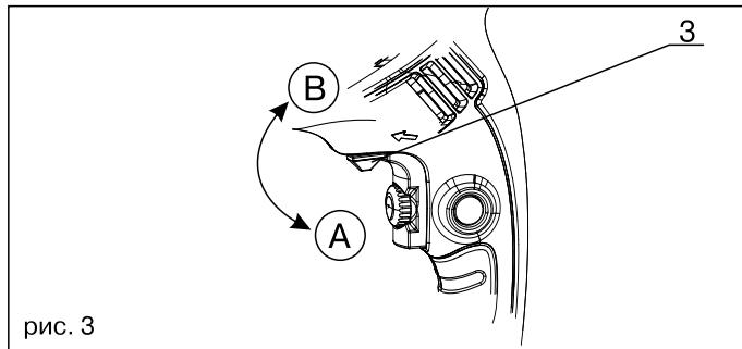
Изменение направления вращения возможно только на выключенном инструменте. Переключателем направления вращения **3** можно изменять направление вращения патрона. Положение **A** - вращение по часовой стрелке. Применяется для сверления и завинчивания шурупов. Положение **B** - вращение против часовой стрелки. Применяется для выворачивания винтов/шурупов и отвинчивания гаек.
