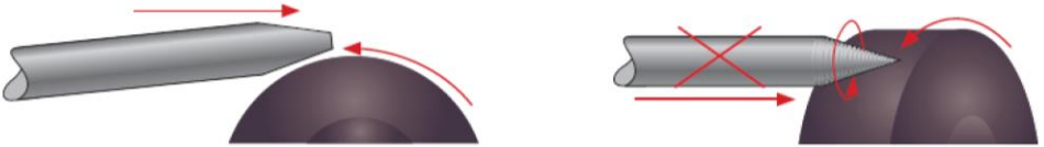
A - зварювання на постійному струмі (DC) Б - зварювання на змінному струмі (AC) de - діаметр вольфрамового електроду
