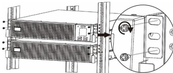
**ПРИМЕЧАНИЕ.** В связи с большим весом оборудования обязательным требованием является использование кронштейнов для монтажа в стойке (направляющей с L-образной опорой). По той же причине рекомендуется устанавливать блок батарей для ИБП в нижней части корпуса стойки.
