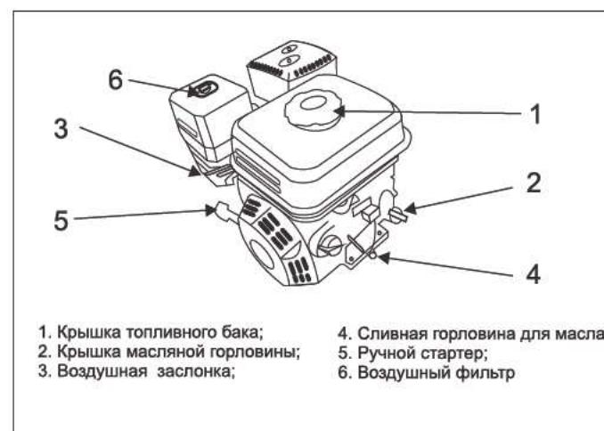
1. Крышка топливного бака;
