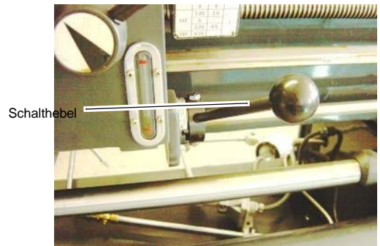
Рис. 4-3: Рукоятка переключения вращения шпинделя
