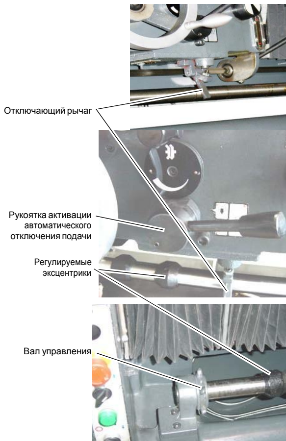
Рис. 4-17: Механизм отключения продольной подачи
