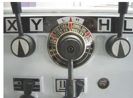
Рис.4-2: Рукоятка установки числа оборотов шпинделя
