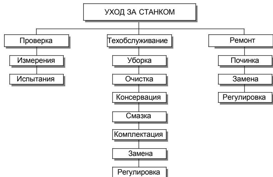
Рис.6-1: Уход согласно DIN 31051
