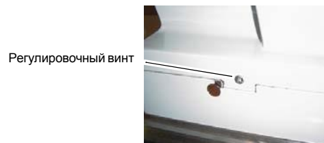
Рис.4-25: Смещение задней бабки
