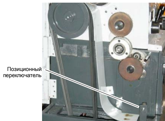
Рис.1-3: Позиционный переключатель защитного кожуха
