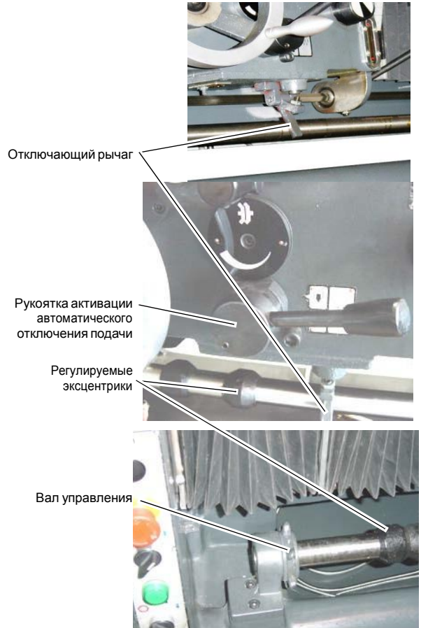
Рис. 4-17: Механизм отключения продольной подачи
