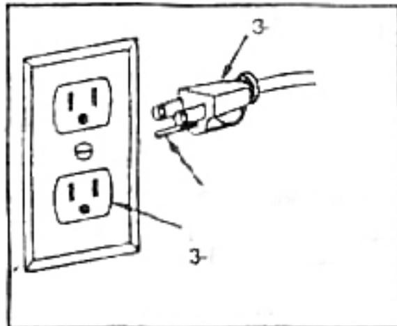
ли інструкцію по заземленню або, якщо ви не впевнені в правильності заземлення, перевірте це за допомогою кваліфікованого електрика або людини з сервісного центру. Використовуйте тільки подовжених електричних дроти, які мають 3-у вилку на заземляючому дроті і 3-й отвір в розетці, як показано на мал. А. Немедленно слід відремонтувати або замінити несправний або такий, що зносився шнур.
