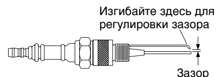
Рис. 15. Регулировка зазора свечи зажигания, нагреватели мощностью 20, 29 и 44 кВт
