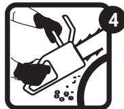
Рис.5: 4 Правильне положення рук на електропилці при роботі з пилою.
