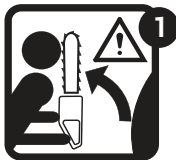
Рис.3: 1,2 Забороняється працювати кінцем шини!
