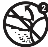
Рис.3: 1,2 Забороняється працювати кінцем шини!
