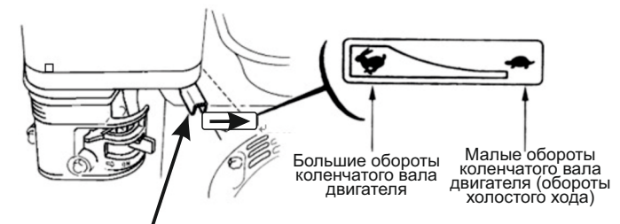
Рычаг управления дроссельной заслонкой
