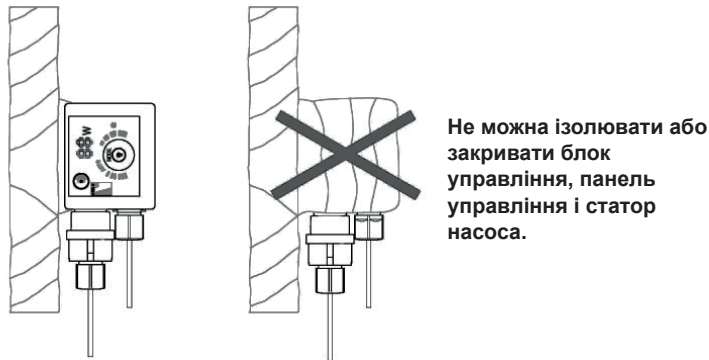
Теплоізоляція корпусу і трубопроводів насоса призначена для зменшення втрати тепла в насосі і трубопроводах і захисту їх від обмерзання.
