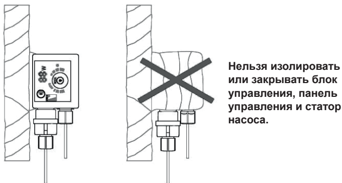
Тепловая изоляция корпуса насоса.
