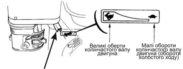
Важіль управління дросельною заслінкою
