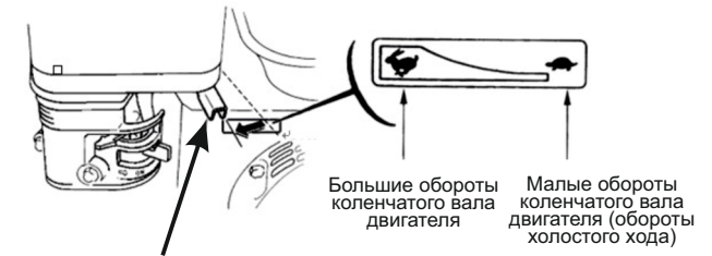
Рычаг управления дроссельной заслонкой
