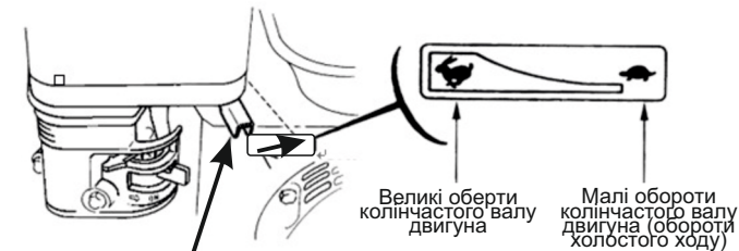
Важіль управління дросельною заслінкою
