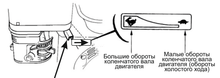
Рычаг управления дроссельной заслонкой
