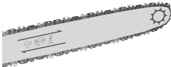
3.1.4 Розмістіть ланки ланцюга навколо приводного зубчастого колеса (зірочки) пили. Розмістіть шину з зубчастим упором натягувача ланцюга таким чином, щоб напрямні втулки вільно увійшли в отвори на шині.
