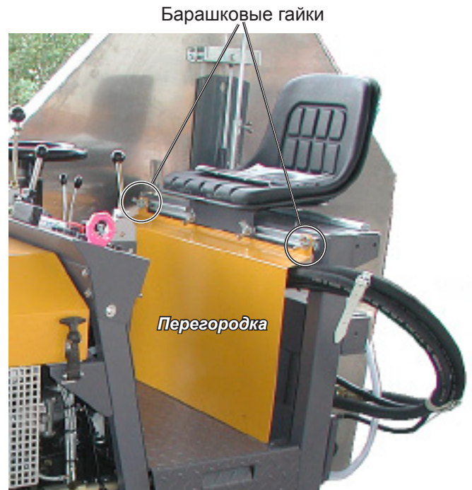
Перегорodka на месте оператора (гидрошланги выходят слева для резки справа) Рис. 7.7
