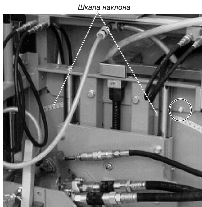
Винт для фиксации угла 90° режущей консоли
