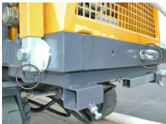
Тяговая проушина и крановая проушина спереди
