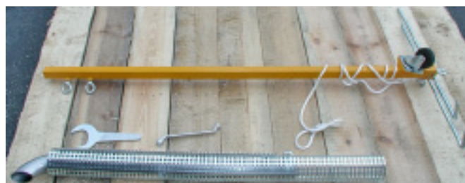
Снятые консоль переднего визира и глушитель
