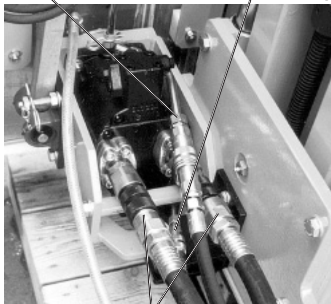
Прямой, обратный разъемы Рис. 7.4 Двигатель привода диска, гидрошланги
