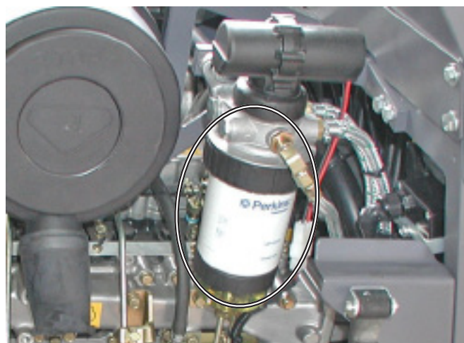
CF-6020 слева, топливный фильтр с отстойным фильтром внизу (капот открыт) Рис. 8.19
