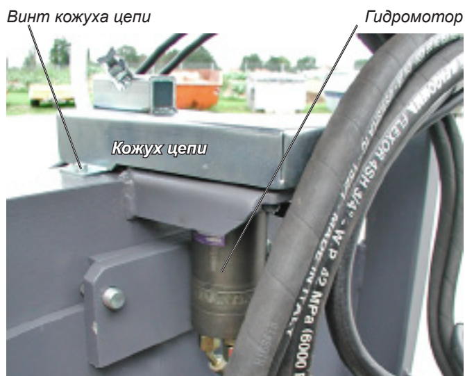
CF-6020 Место оператора сзади, цепной редуктор (крышка, пластина подножки сняты) Рис. 8.9
