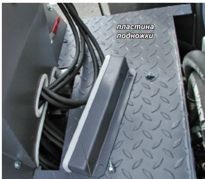
Место оператора, крышка между защитной пластиной подножки и пультом управления, снята (крышка уже снята) Рис. 8.2
