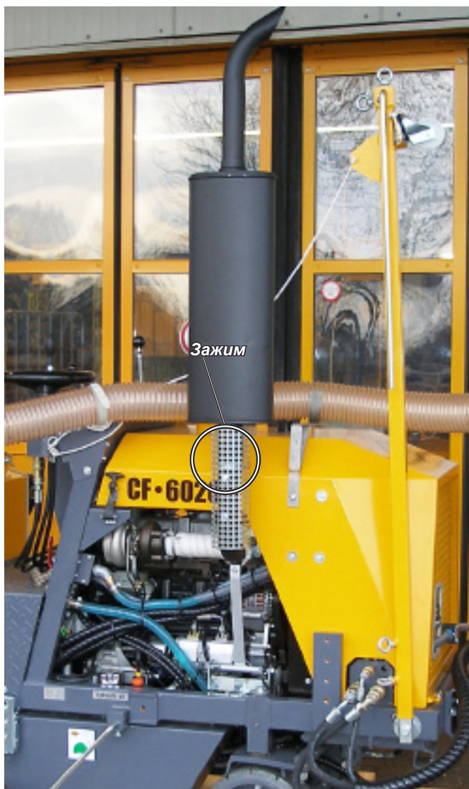
CF-6020, Глушитель смонтирован, консоль переднего визира поднята Рис. 9.1
