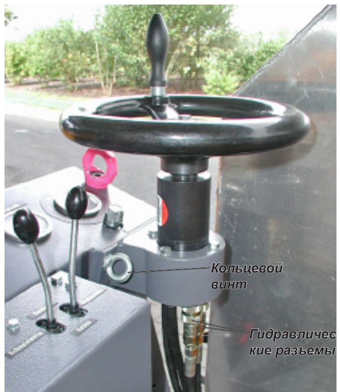
Рулевая консоль смонтирована справа
