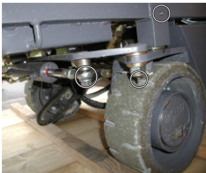
Места смазки, прессмасленки рулевого управления, здесь переднее левое колесо и “проушина” гидравлического рулевого цилиндра (смазка кистью) Рис. 8.25
