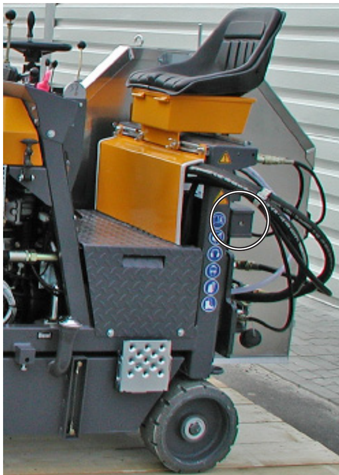
Крепеж для держателя кожуха диска, слева
