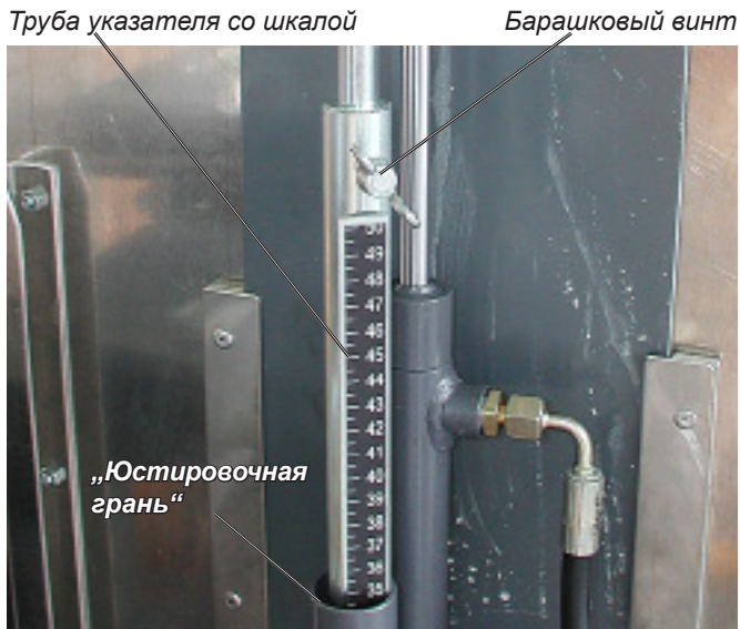
CF-6020, Указатель глубины резки, кожух диска смонтирован для правосторонней резки Рис. 5.11
