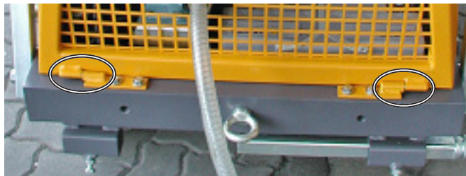
CF-6020 спереди, места смазки капота
