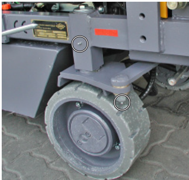
Места смазки, прессмасленки рулевого управления, здесь правое переднее колесо
