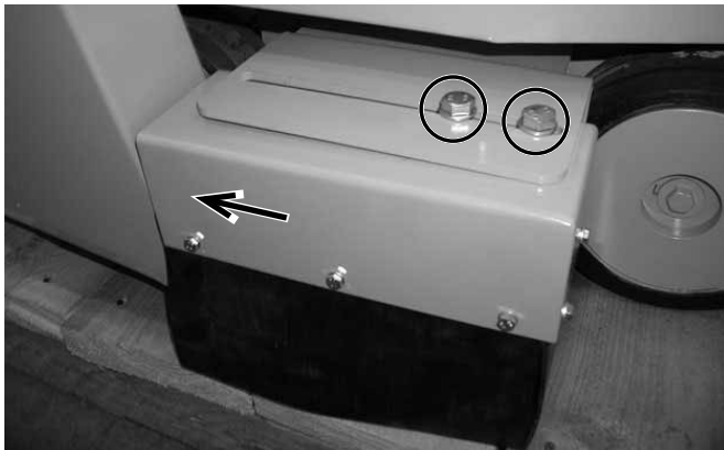
CF-3002 (стандарт), брызговик для левостор. резки смонтирован и подогнан к кожуху диска
