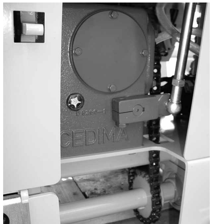
CF-3002 D (свежий бетон) сзади снизу, цепной привод-подачи
