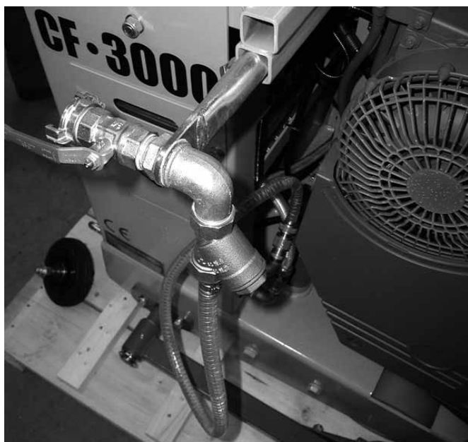
Разъем Гека подачи воды с запорным краном на выдвигной трубе Рис. 4.31
