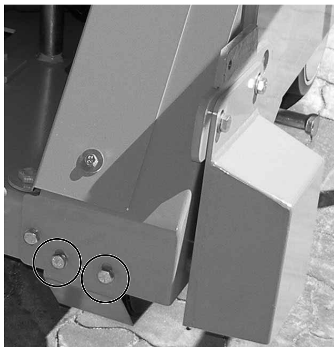
CF-3002D (спереди, слева) передний винты с шайбами , направляющего лотка ремней Рис. 4.19
