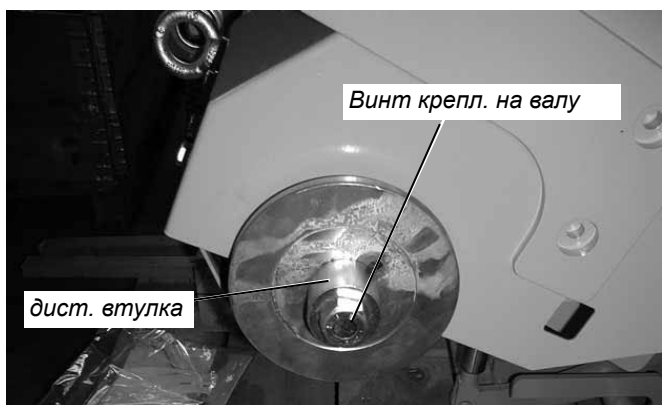
CF-3002 (стандарт), крышка крепления диска, режущего вала (слева снята) Рис. 4.70
