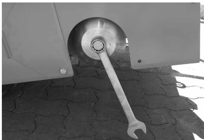
Защитная пластина повернута в сторону, отвинчивание центрального винта режущего вала Рис.4.59
