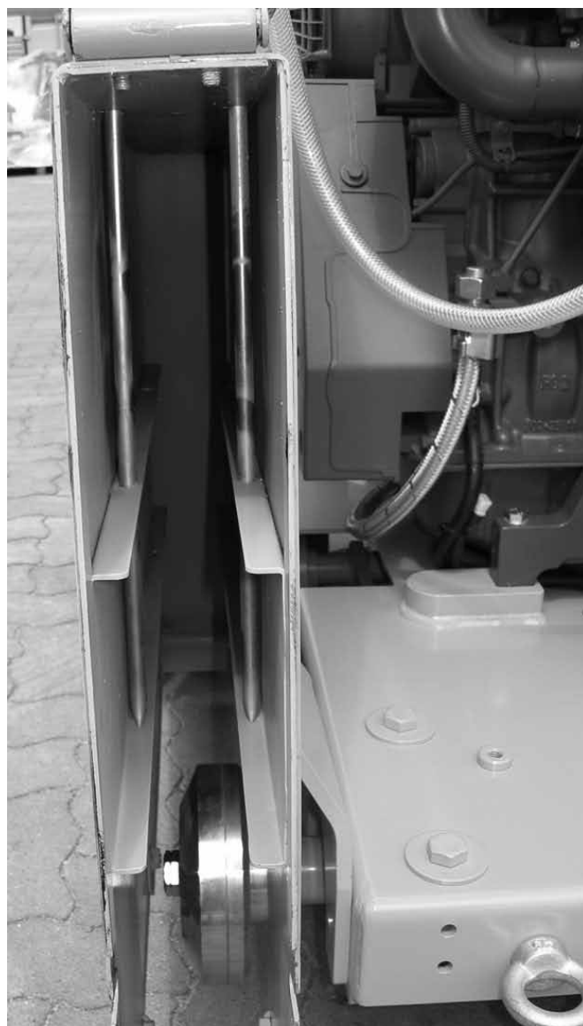
CF-3002 D (стандарт) колпак кожуха открыт. Вид на водяные форсунки
