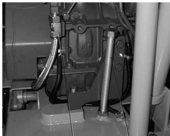
CF-3002 D спереди, шланг слива моторн.масла, винт упора глубины резки с контрагайкой (ограничитель опускания режущего вала) Рис. 4.33-
