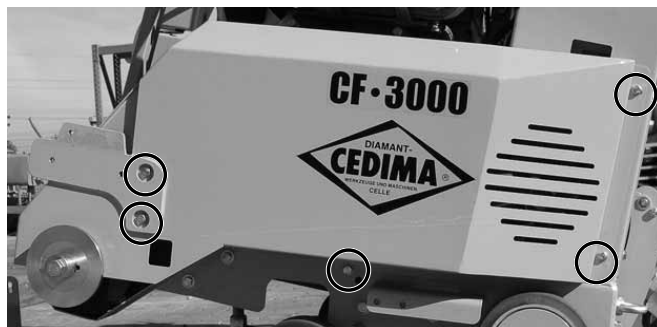
CF-3002D (слева), винты, шайбы на кожухе клиновых ремней Рис. 4.24
