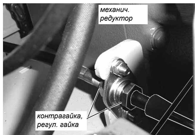
Трос Боудена рычага подачи, регулир. устройство перед механич. редуктором
