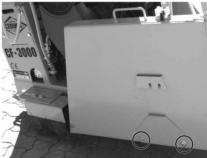
Винты защитной пластины (кожух смонтирован справа) Рис.4.58
