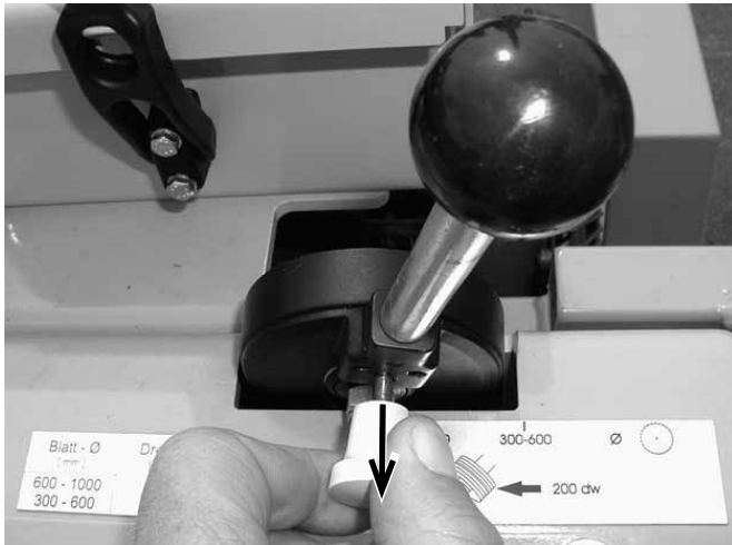
CF-3002 (стандарт), рычаг частоты вращения двигателя в положении выше холостого хода стопор оттянут Рис. 4.66
