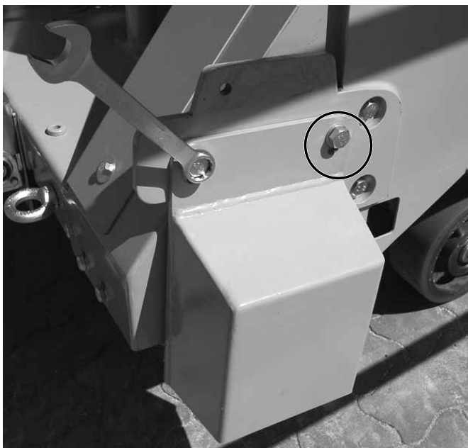
CF-3002D (слева), винты, шайбы на кожухе вала Рис. 4.22
