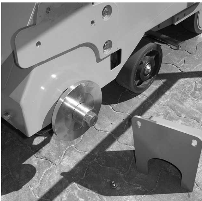
CF-3002D (слева), кожух вала снят Рис. 4.23
