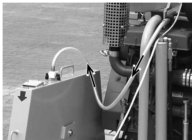
CF-3002 D подача воды к (стандарт) кожуху диска
