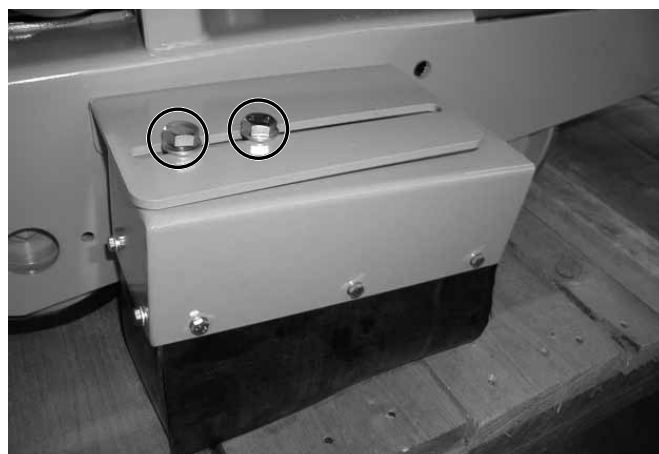
CF-3002 (стандарт), брызговик для резки справа (кожух диска снят) Рис. 4.72
