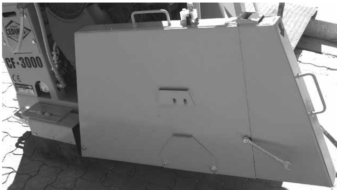
Оба наружных винта колпака, (кожух диска смонтирован справа) Рис. 4.61
