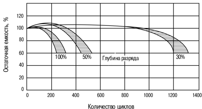
Рис. 8. Зависимость количества циклов от глубины разряда аккумуляторов
