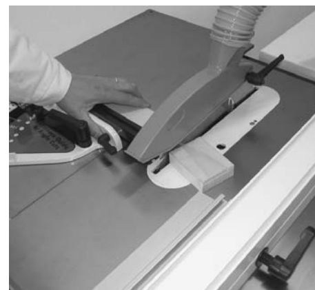
А.3. Поперечный распил при помощи упора
