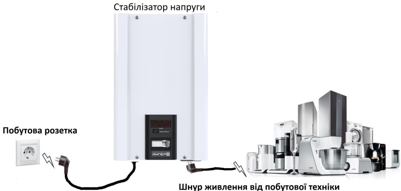
Рисунок 6. Підключення стабілізатора до мережі
