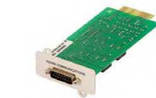
Релейная плата BD (для ИБП Eaton 9130)
