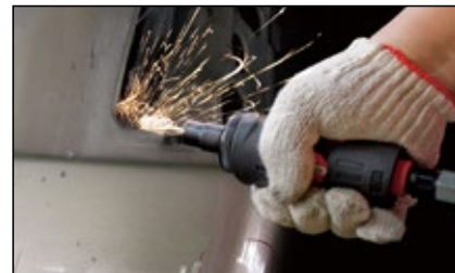
▲ Operation of Mini Die Grinder
