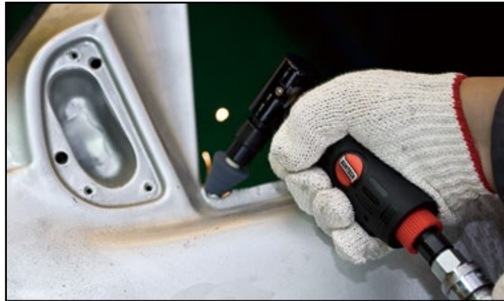
▲ Operation of Mini Die Grinder
