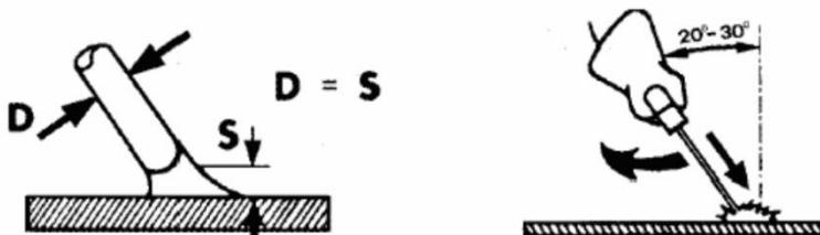
Завершая процесс сварки, следует правильно заварить кратер, который образуется в процессе сварочных работ от контакта электрода со свариваемой поверхностью. Это необходимо сделать во избежание возможного возникновения трещин в сварочном шве. Не следует обрывать дугу, резко отводя электрод от изделия. Необходимо прекратить перемещение электрода и медленно удлинить дугу до ее обрыва (расплавляющийся при этом электродный металл заполнит кратер).
