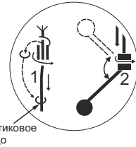
Установка балласта на поплавок
