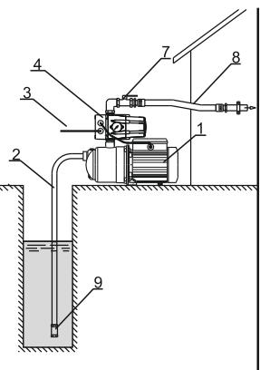
Малюнок 3. Установка з поверхневим насосом без додаткового резервуара
