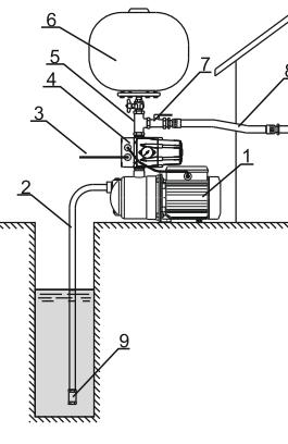
Малюнок 2. Установка з поверхневим насосом
