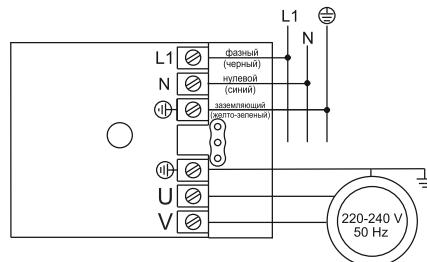
Для однофазного насоса сила тока не может быть больше, чем 10 А (для контроллера 779558 сила тока не может быть больше, чем 16 А), а максимальная мощность электродвигателя не должна превышать 1,1 кВт (для контроллера 779558 не должна превышать 2,2 кВт). Убедитесь в правильности подключения электрической схемы (см. электрическую схему). Рекомендуем установку дифференциального выключателя (УЗО) с током отключения равным 30 мА. Подводящий кабель должен соответствовать стандартам ЕЭС.
