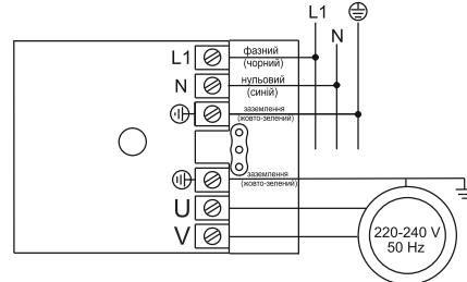
Для однофазного насоса сила струму не може бути більше, ніж 10 А (для контролера 779558 сила струму не може бути більше, ніж 16 А), а максимальна потужність електродвигуна не повинна перевищувати 1,1 кВт (для 779558 не повинна перевищувати 2,2 кВт). Переконайтесь в правильності підключення електричної схеми (див. Електричну схему). Рекомендуємо установку диференціального вимикача (УЗО) з струмом відключення рівним 30 мА. Підвідний кабель повинен відповісти стандартам ЄСЕ.
