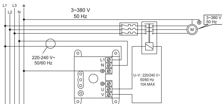
**ВНИМАНИЕ!** Для подключения контроллера и электронасоса к электропитанию необходимо использовать двухполюсный выключатель соответствующего номинала, оборудованный контактной группой с расстоянием между контактами более 3 мм.
