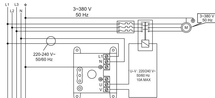
**УВАГА!** Для підключення контролера і електронасоса до електро живлення необхідно використовувати двополюсний вимикач відповідного номіналу, обладнаний контактною групою з відстанню між контактами більше 3мм.
