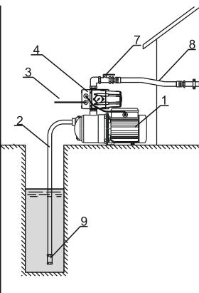
Рисунок 3. Установка с поверхностным насосом без дополнительного резервуара
