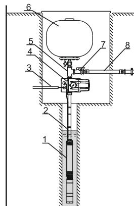
Малюнок 1. Установка з глибинним насосом
