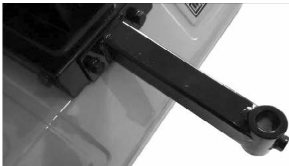
Установка кронштейну для сошника
