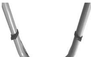
Установка стяжки для кабелю
