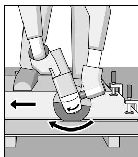
Električni alat mora uvek da se vodi u suprotnom smeru kretanja. Inače postoji opasnost, da se **nekontrolisano** istisne iz reza.
