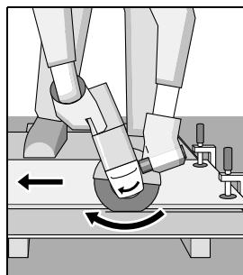
Električni alat mora se uvijek voditi protuhodno. Međutim postoji opasnost da se **nekontrolirano** istisne iz reza. Kod rezanja profila i četverokutnih cijevi najbolje je da stavite na najmanji presjek.
