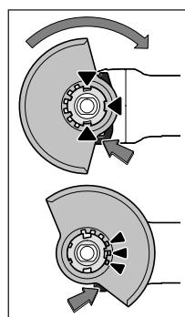
Поставете предпазния кожух **6** на захващащото стъпало на електроинструмента така, че кодиращите гърбици да съвпаднат с каналите на стъпалото. При това натиснете и задръжте освобождаващия лост **1**. Притиснете предпазния кожух **6** към шийката на електроинструмента, докато борта на предпазния кожух допре до фланеца на електроинструмента и завъртете предпазния кожух, докато чуете отчетливо прещракване.
