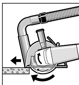
Uključite električni alat i stavite ga sa prednjim delom klizača vodice na radni komad. Gurajte električni alat sa umerenim pomeranjem napred koje je prilagođeno materijalu koji se obradjuje.
