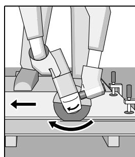
Всегда ведите электроинструмент против направления вращения. В противном случае возникает опасность неконтролируемого выхода из прорези. При резке профилей или четырехгранных труб начинайте рез на наименьшем поперечном сечении.
