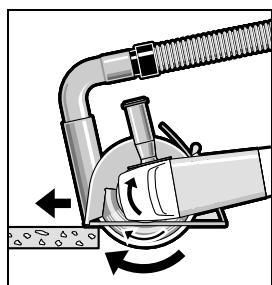
Włączyć elektronarzędzie i przyłożyć przednią częścią prowadnicy do ciętego elementu. Pracować z równomiernym, optymalnie dopasowanym do danego typu materiału posuwem.
