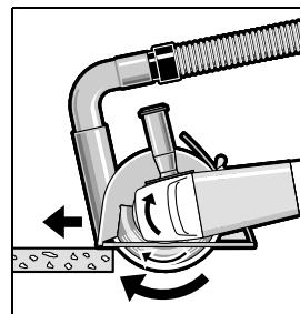
Kapcsolja be az elektromos kéziszerszámot és helyezze fel a vezetőszán első részével a megmunkálásra kerülő munkadarabra. Az elektromos kéziszerszámot a megmunkálásra kerülő anyagnak megfelelő mérőként előtolással mozgassa előre.
