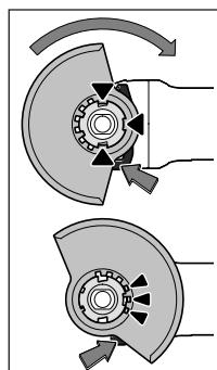
Stavite zaštitnu haubu **6** na prihvati na električnom alatu, da kodni ispusti zaštitne haube budu usaglašeni sa prihvatom. Pritisnite i držite pritom polugu za deblokadu **1**. Pritisakajte zaštitnu haubu **6** sve dok venac zaštitne haube ne nalegne na prirubnicu električnog alata i okrećite zaštitnu haubu sve dok jasno i da se čuje ne uskoči. Prilagodite poziciju zaštitne haube **6** potrebama rada.
