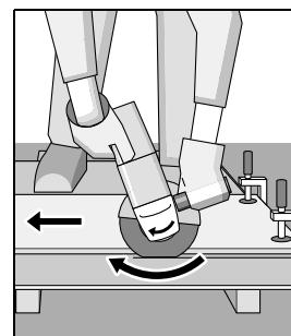
С електроинструмента трябва да се работи винаги на принципа на противоположните движения. В противен случай съществува опасност да изскочи **неконтролируемо** от среза.
