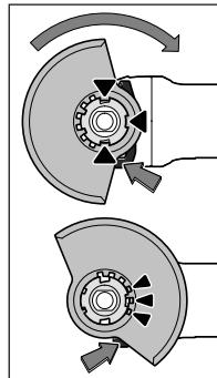
Tegye fel a **6** védőbúrát az elektromos kéziszerszámon a megfelelő helyre, amíg a védőbúra kódolóbütykei egybe nem esnek a rögzítő egység megfelelő bemélyedéseihez. Nyomja le és tartsa lenyomva az **1** reteszélésfeloldó kart.
