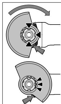
Priložte ochranný kryt **6** na držiak na ručnom elektrickom náradí tak, aby sa kódovacie výstupky ochranného krytu zhodovali s kódovacími prvkami držiaka. Stlačte a podržte stlačenú uvoľňovaciu páku **1**. Zatlačte ochranný kryt **6** na kŕčok vretena, až bude pás ochranného krytu sedieť na prírube ručného elektrického náradia a otočte ochranný kryt tak, aby počutelne zaskočil.
