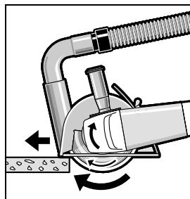
Uključite električni alat i stavite ga na izradak sa prednjim dijelom vodilice. Pomičite električni alat sa umjeranim posmakom prilagođenim obradivanim materijalu.
