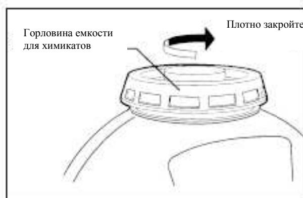
После надежного расположения крышки емкости, надежно закройте данную крышку. Иначе, химикаты прольются на вас при переносе устройства на вашей спине.
