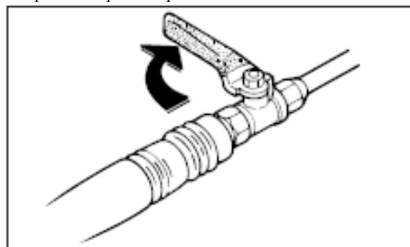
2 Поверните дроссельный рычаг на низкоскоростную позицию.
