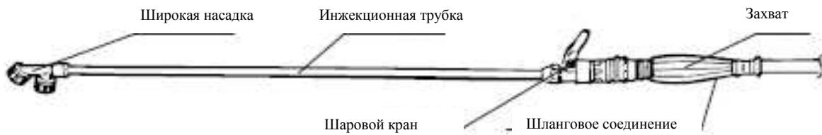
После проверки уплотнения надежно прикрепите инжекционную трубку к захвату, а широкую насадку к инжекционной трубке. Данную процедуру необходимо проделать для проверки устройства на наличие утечек воды. Перетяжение, тем не менее, может вызвать экструзию или повреждение уплотнения, поэтому правильное давление затяга очень важно в данном случае.
