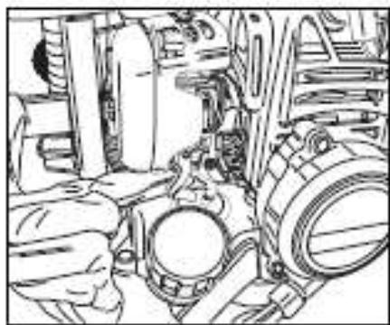
2 Полностью закройте дроссель. (При жаркой погоде или когда двигатель сильно нагрет, дроссель должен быть частично или полностью открыт).
