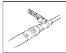
1 Выполните заливку. Медленно нажмите на заливной насос, расположенный перед карбюратором, несколько раз и убедитесь, что топливо идет по заливному насосу и возвращается в емкость через прозрачный возвратный топливопровод.
