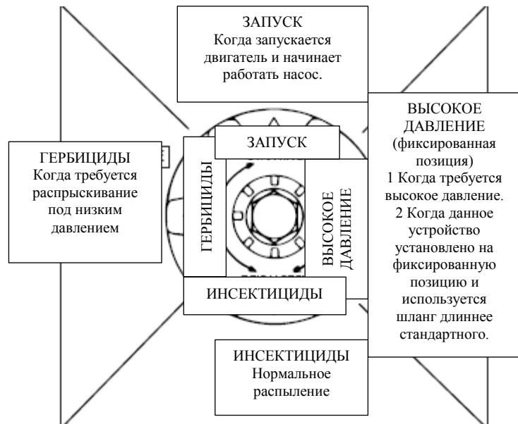
2 После настройки насоса и величины распыления на устройстве, установите дроссельный рычаг на высокоскоростную позицию.
