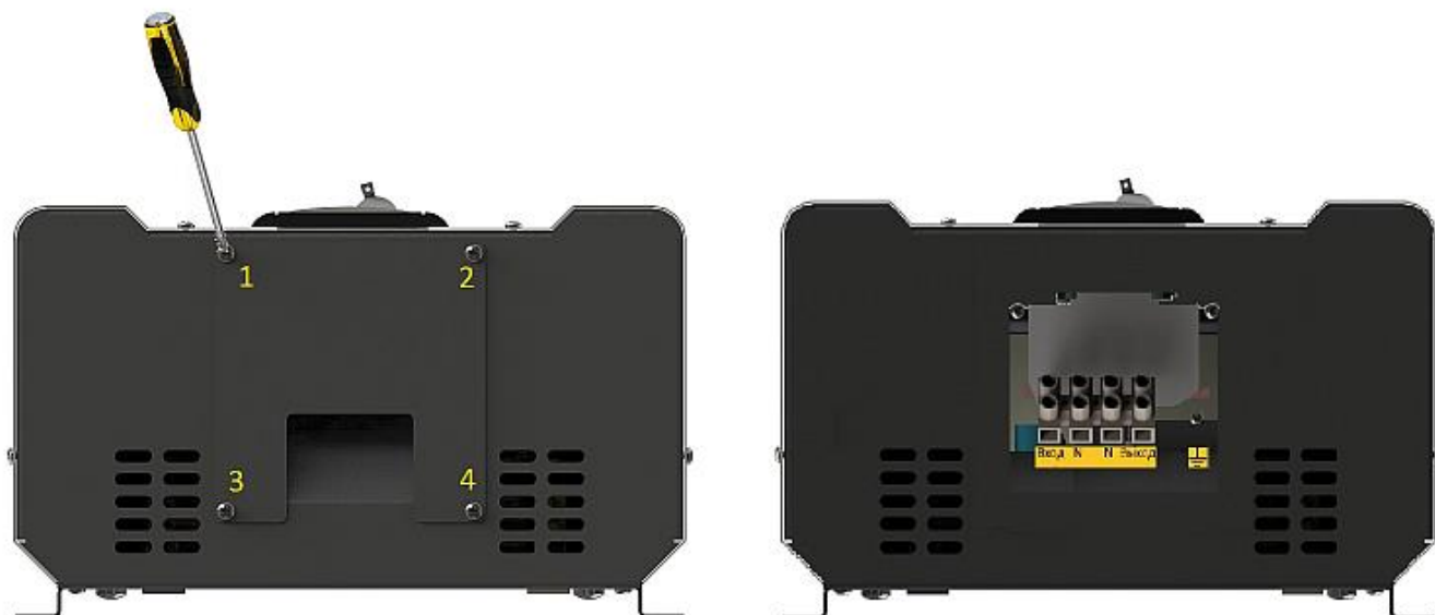
Рисунок 8. Схема снятия защитной крышки снизу корпуса стабилизатора
