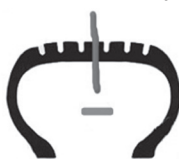
Неправильне встановлення джгута
