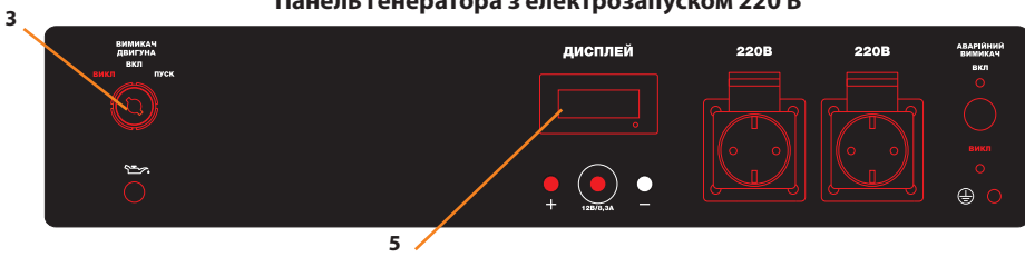
Панель генератора з електрозапуском 220 В та ATS
