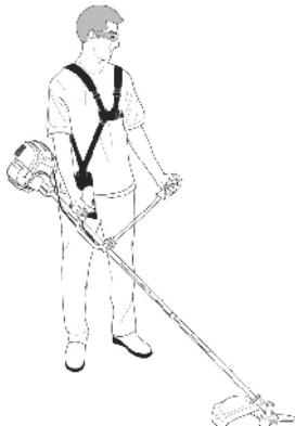
Po nastartování motoru křovinořez/vyžínač zavěšte k Vašemu závěsnému postroji a uchopte rádně za ovládací rukojeti.
