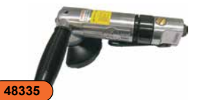
Пневматическая углошлифовальная машина 4", 11000 об./мин., 170 л/м
