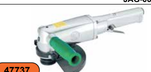
Пневматическая углошлифовальная машина 7", 7000 об./мин., 257 л/м
