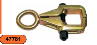
Зажим для кузовных работ, 2 направления, нагрузка: продольно - 3 т, поперечно - 2 т
