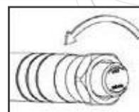
2. Используя регулировочную рукоятку выставить необходимый момент затяжки.
