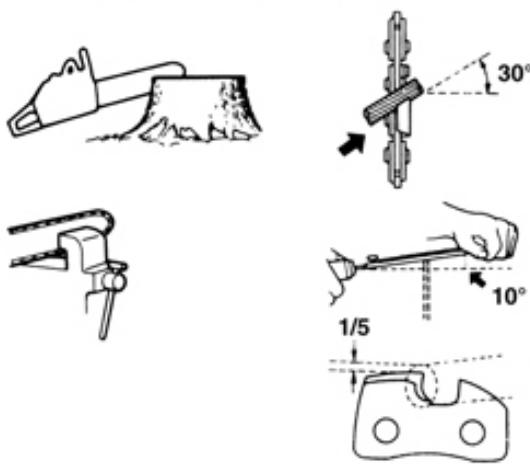
Після того, як всі різці були заточені, перевірте глибину канавки. Обробіть її напилком у разі потреби, як вказано на малюнку.
