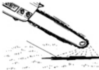
Швидкість та характер змащення (подання мастила на ланцюг) можна відрегулювати за допомогою викрутки. Для цього вставте її у спеціальний отвір, як вказано на малюнку. Відрегулюйте у відповідності з умовами роботи з бензопилою.
