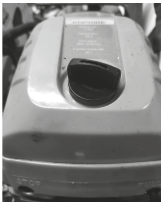
Рисунок 4. Схема розташування та фіксації відсіку повітряного фільтра.
