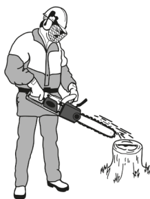
Рисунок 6. Схема перевірки системи подачі мастила.
