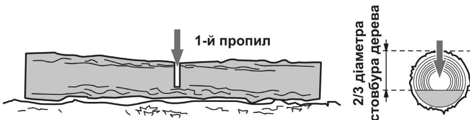
Рисунок 13. Схема попереднього розпилу колоди.
