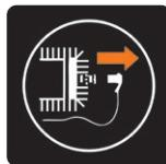
При обслуживании или ремонте отсоедините провод от свечи зажигания.
