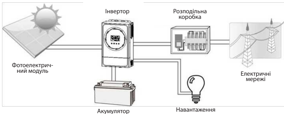
Малюнок 1 Загальний огляд фотоелектричної системи
