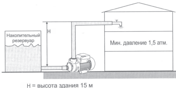
H = высота здания 15 м
