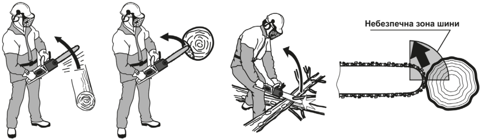
Рисунок 2. Приклади виникнення небезпечної віддачі виробу.
