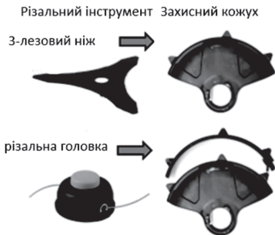
Рисунок 8. Комбінація використання різального інструменту із захисним кожухом.
