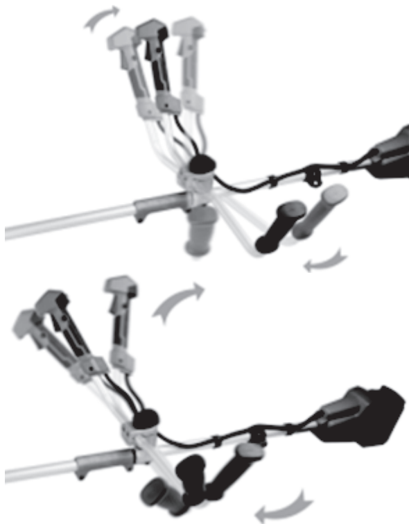
Рисунок 7. Схема регулювання кута нахилу руків'я.
