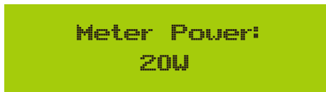
Рис. 7.36 Функція нульового експорту через увімкнення лічильника електроенергії
