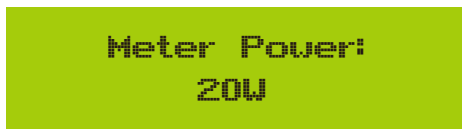
Рис. 7.36 Функція нульового експорту через увімкнення лічильника електроенергії
