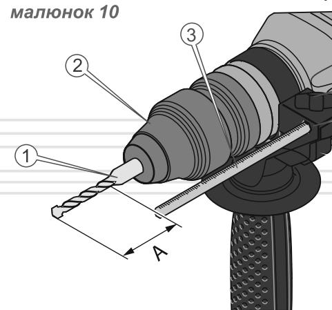
1. Відкрутіть гайку-баранець (5) та вставте обмежувач (3) в отвір на допоміжній рукоятці (4).
