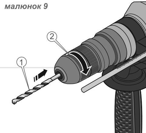
1. Очистіть хвостовик свердла від пилу та бруду.
