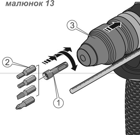
1. Очистіть хвостовик тримача біти стандарту SDS-plus (1) від пилу та бруду. Змастіть хвостовик тонким шаром машинного масла.
