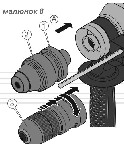
1. Натисніть на обойму (1) в напрямку стрілки (A) та від'єднайте патрон стандарту SDS-plus (2).
