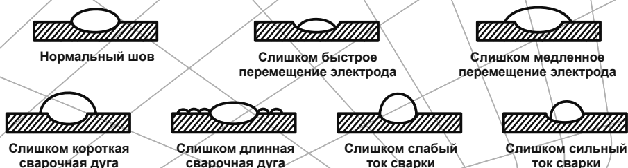
Рисунок 6. Основные виды ошибок при сварке полуавтоматом.
