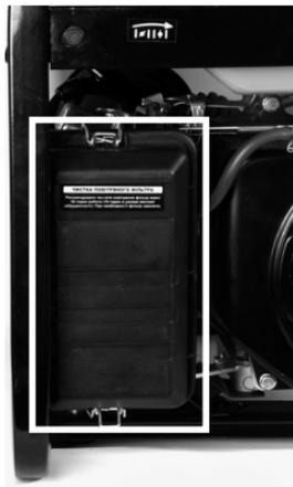
Снимите крышку корпуса воздушного фильтра.
