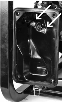
Установите основное корпуса воздушного фильтра на исходное место и закрепите крепежными гайками
