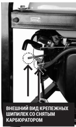
После демонтажа штатного карбюратора можно установить газовый комплект на место штатного карбюратора
