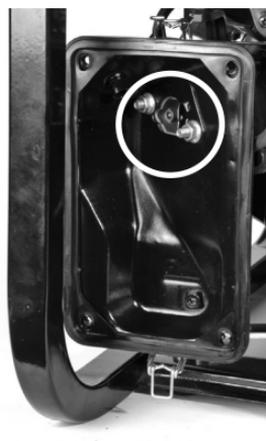
После снятия фильтрующего элемента открутите две гайки фиксации корпуса и снимите его основание.
