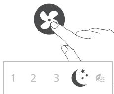
**Természetes szellő üzemmód (☴):** A levegő természetes mozgását utánozva növeli vagy csökkenti a ventilátor fordulatszámát, és a szabadtéri szellő frissítő érzését teremti meg a helyiségen.
