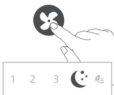
**Modul Briză naturală (⾵):** Reduce și crește turația ventilatorului pentru a imita mișcarea naturală a aerului și a aduce senzația de prospetime a unei brize în cameră.
