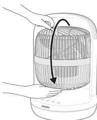
Lopatka ventilátora je na začiatku umiestnená smerom nahor. Pred prvým použitím nastavte ventilátor do správneho uhla, napríklad smerom dopredu.
