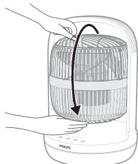
Lopatica ventilatorja je na začetku obrnjena navzgor. Ventilator pred prvo uporabo postavite pod ustreznim kotom, npr. obrnite naprej.
