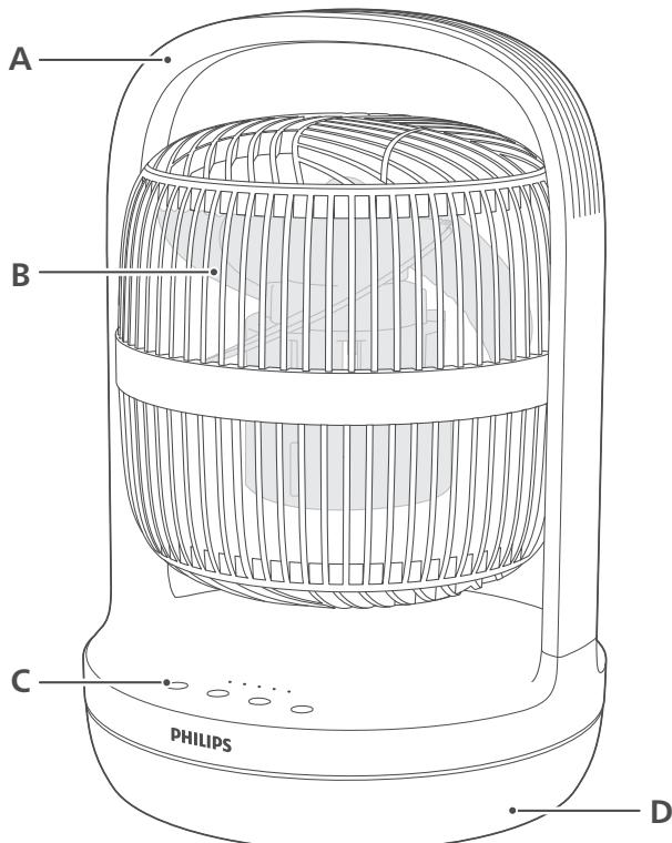
**A** Rukoväť**B** Lopatka ventilátora**C** Ovládacie tlačidlá**D** Základňa ventilátora
