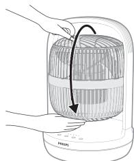
El aspa del ventilador se coloca inicialmente hacia arriba. Antes de usarlo por primera vez, ajuste el ventilador a un ángulo adecuado, por ejemplo, hacia la parte frontal.
