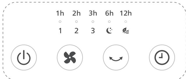
**⊕** Tlačidlo vypínača**↶** Tlačidlo otáčania**1, 2, 3** Indikátor rýchlosťi ventilátora**☾** Indikátor spánkového režimu**✖** Volič rýchlosťi ventilátora/režimu**⌚** Tlačidlo časovača**1h** Ukazovateľ času**☾** Indikátor režimu prirodzeného vánku
