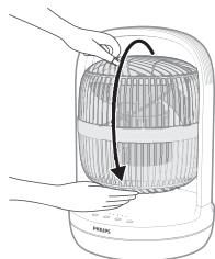
Лопаті вентилятора спочатку спрямовані догори. Перед першим використанням відрегулюйте вентилятор під відповідним кутом, наприклад, щоб він був спрямований вперед.
