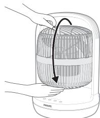
A ventilátorlapátot kezdetben felfelé fordítva kell elhelyezni. Az első használat előtt állítsa be a ventilátort a megfelelő szögbe, például előrefelé.
