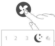
**Modalità vento naturale (☴):** regola la velocità del ventilatore verso l'alto e verso il basso per imitare il movimento naturale dell'aria e dare la sensazione di una brezza rinfrescante all'interno della stanza.
