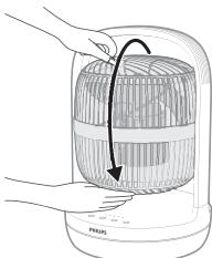
Lopatka ventilátoru je zezačátku nastavena nahoru. Před prvním použitím upravte lopatku do správného úhlu, např. tak, aby mířila dopředu.
